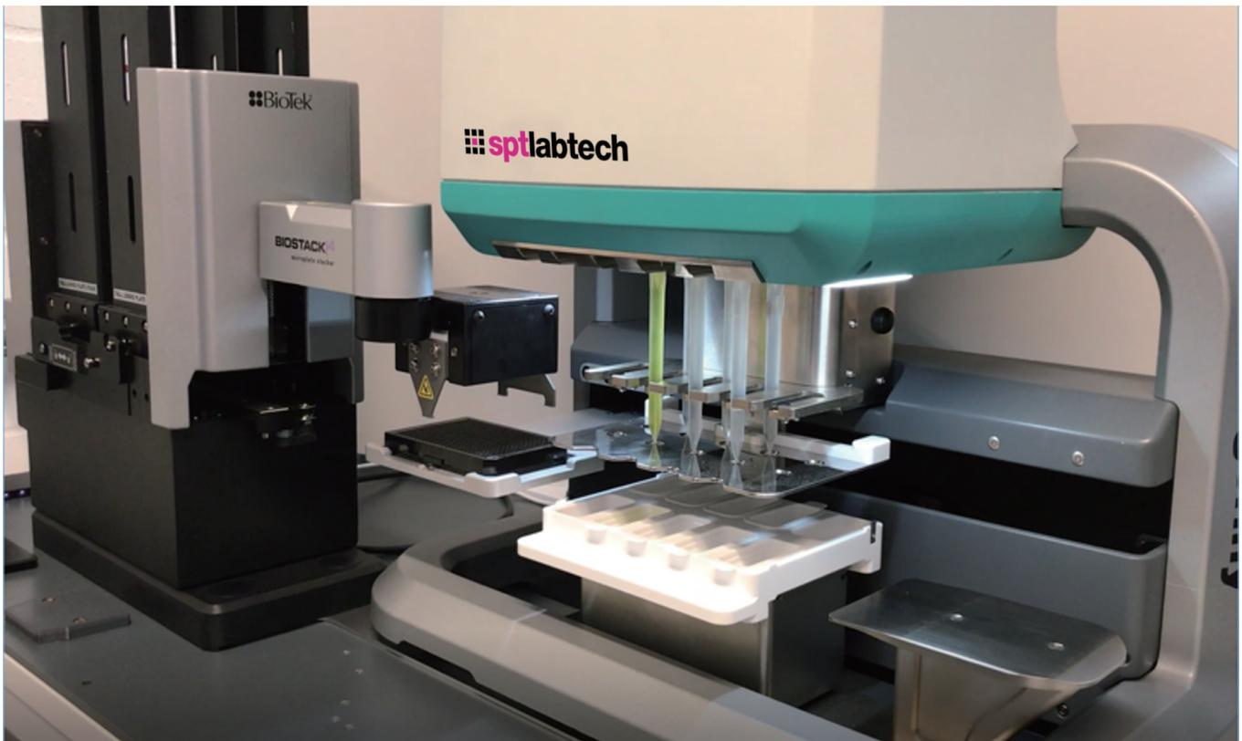
整合机械臂和叠板架，实现高通量自动化分液
