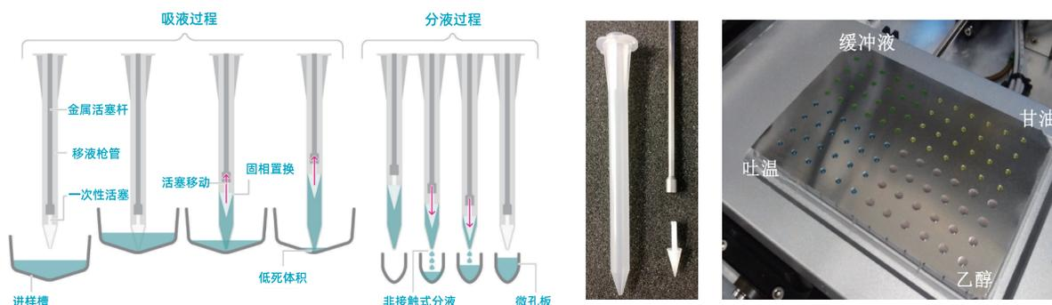
dragonfly<sup>®</sup> discovery的枪头和固相置换移液原理，快速分液并轻松胜任各种粘稠液体的核心“秘密”
