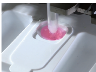
可配备冷槽，减缓胶的凝固
