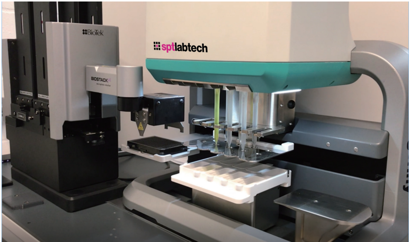
整合机械臂和叠板架，实现高通量自动化分液
